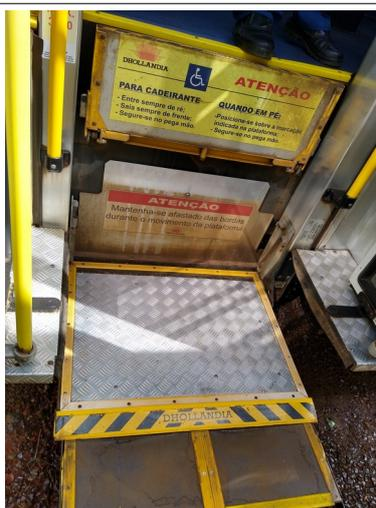
Foto 1 Plataforma Elevatória
