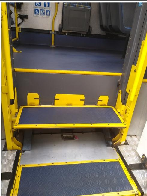
Foto 1 Plataforma Elevatória
