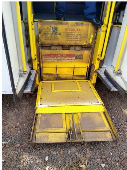
Foto 1 Plataforma Elevatória
