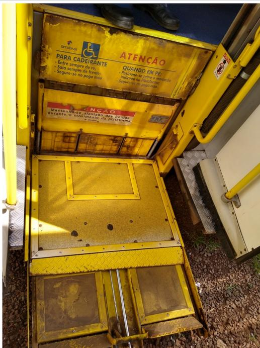
Foto 1 Plataforma Elevatória
