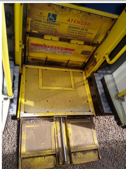
Foto 1 Plataforma Elevatória
