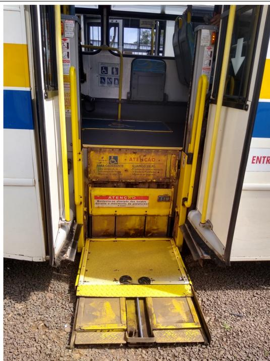
Foto 1 Plataforma Elevatória
