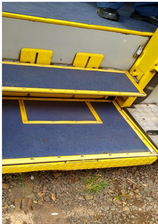
Foto 1 Plataforma Elevatória
