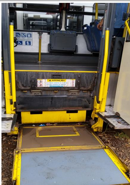
Foto 1 Plataforma Elevatória
