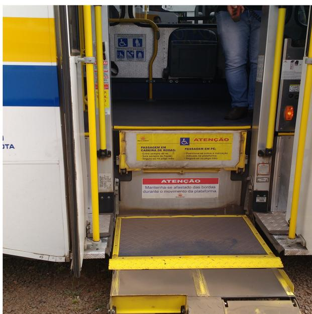
Foto 1 - Plataforma Elevatória
