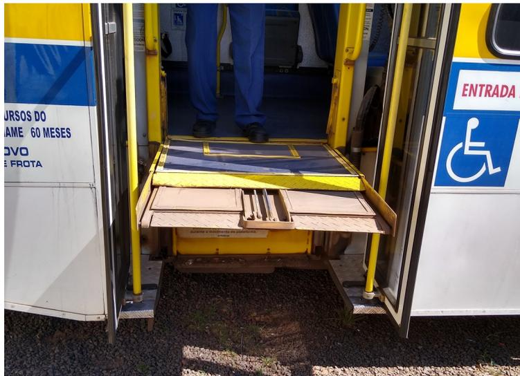
Foto 1 Plataforma Elevatória
