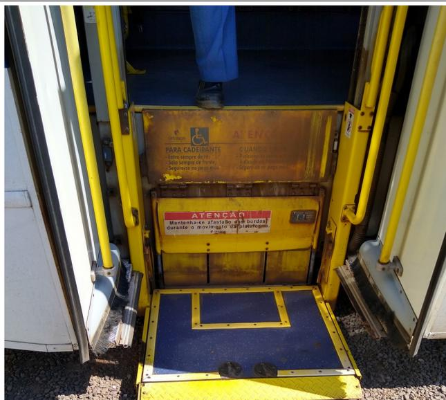
Foto 1 Plataforma Elevatória
