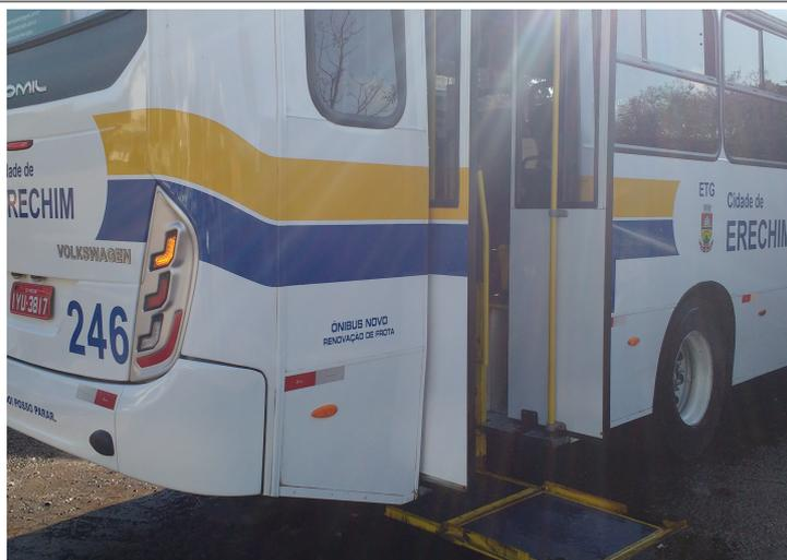
Foto 1 Plataforma Elevatória
