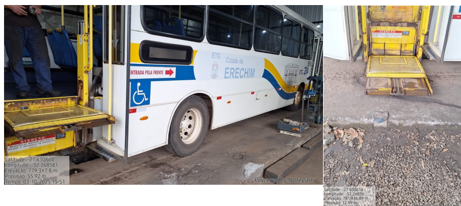
Fotos 5 e 6 Plataforma Elevatória
